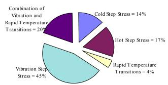
FIGURE 1 - FAILURE PERCENTAGE BY STRESS TYPE
